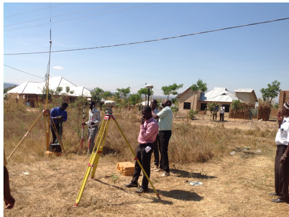
Picha na. 8: Wataalamu wa upimaji Halmashauri ya Manispaa ya Iringa wakipima mipaka ya viwanja kwa kutumia kifaa cha upimaji aina ya 'Real Time Kinematic (RTK)'.
